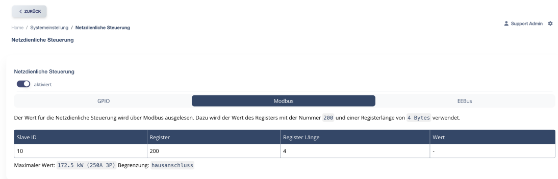
Abbildung 9: Netzdienliche Steuerung MODBUS
